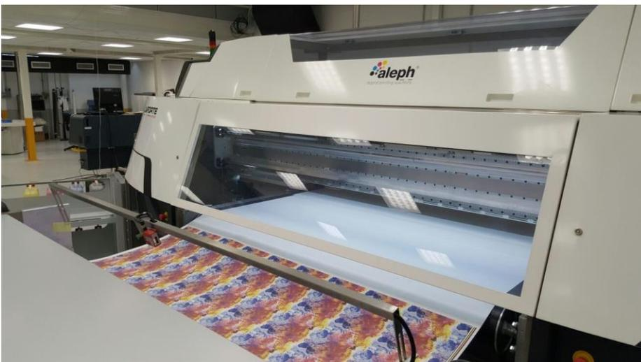
Il plotter LaForte® Paper ha una capacità produttiva molto elevata che consente di raggiungere una velocità di 600mq/h
